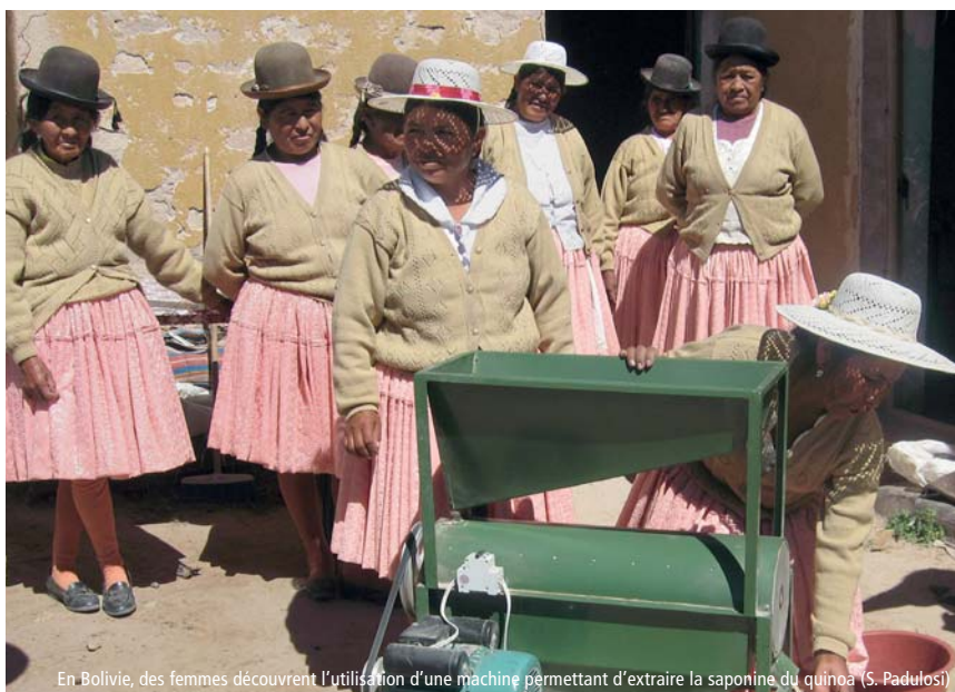
En Bolivie, des femmes découvrent l'utilisation d'une machine permettant d'extraire la saponine du quinoa (S. Padulosi)
