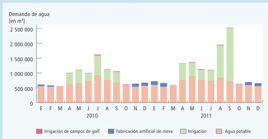
Figura 2.12. Demanda de agua (en m³) durante un año "normal" (2010) y un año "seco" (2011), sin incluir la producción hidroeléctrica Fuente: [1]
